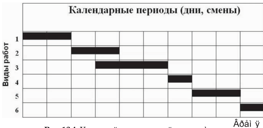
Рис. 12.4. Условный пример линейного графика выполнения работ
